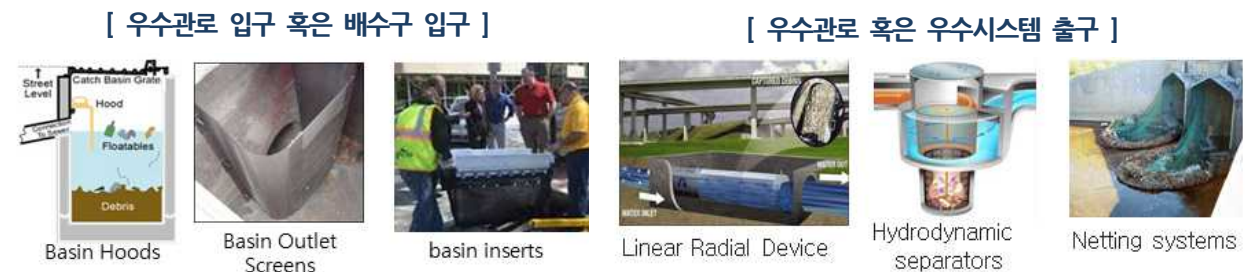
그림 8. 미국, 오폐수 처리시설에 설치한 플라스틱 폐기물 포집장치 예시
