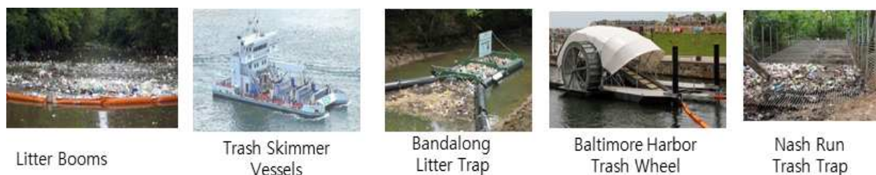
그림 9. 미국, 하천 및 하구에 설치한 해양 플라스틱 포집 장치 예시
