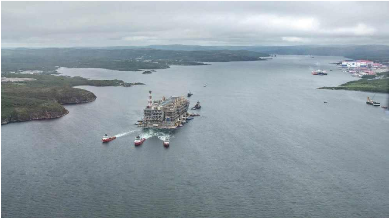
그림. 64만 톤의 LNG 트레인을 견인하는 모습
