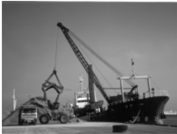
〈그림 4-4〉 크레인을 이용한 모래 하역작업 사진
