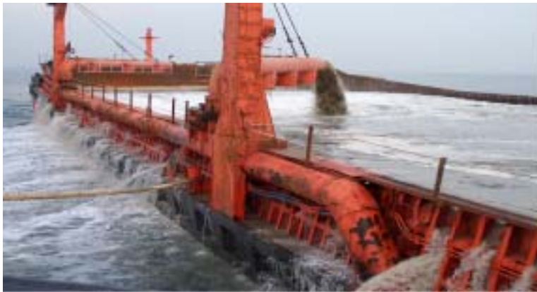
〈그림 3-1〉 채취작업이 이루어지는 동안 채취선에서 잉여해수가 방출되는 모습
