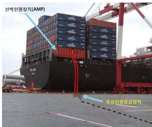
| 그림 3-5 | 선박 육상공급장치(Alternative Maritime Power : AMP)
