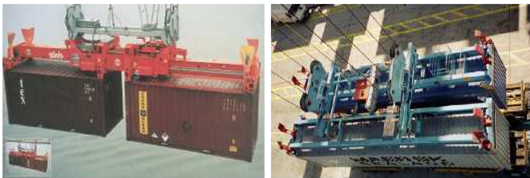
| 그림 3-7 | Twin-Lift와 Tandem Forties 스프레더 현장작업
