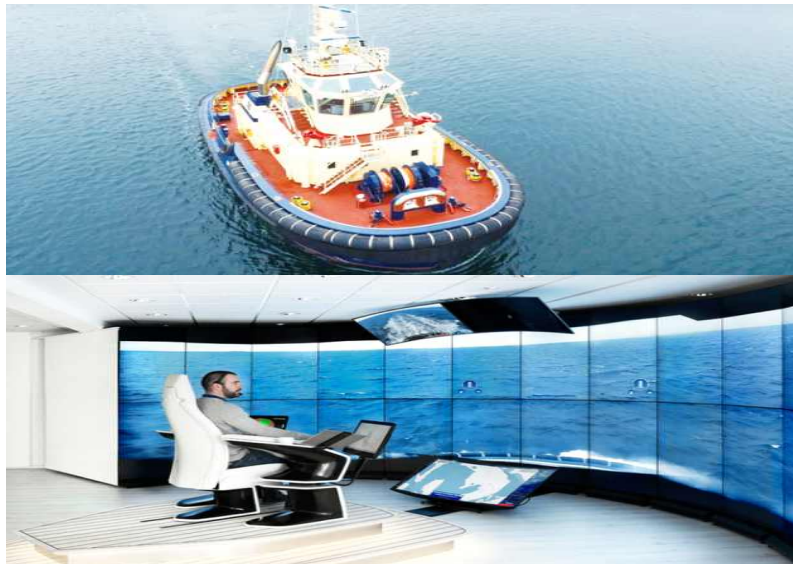
〈그림 3-5〉 세계 최초 원격조종 상선 '스비처 허모드' 호 및 원격조정 조감도
