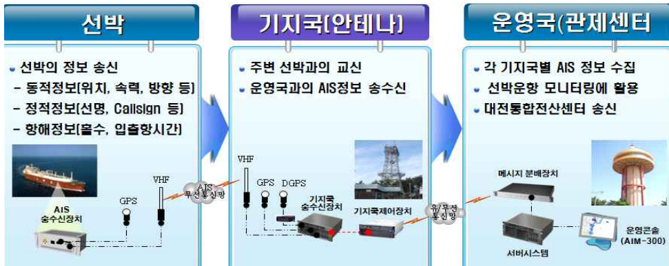
〈그림 3-5〉 선박자동식별 시스템(AIS) 정보 전달체계
