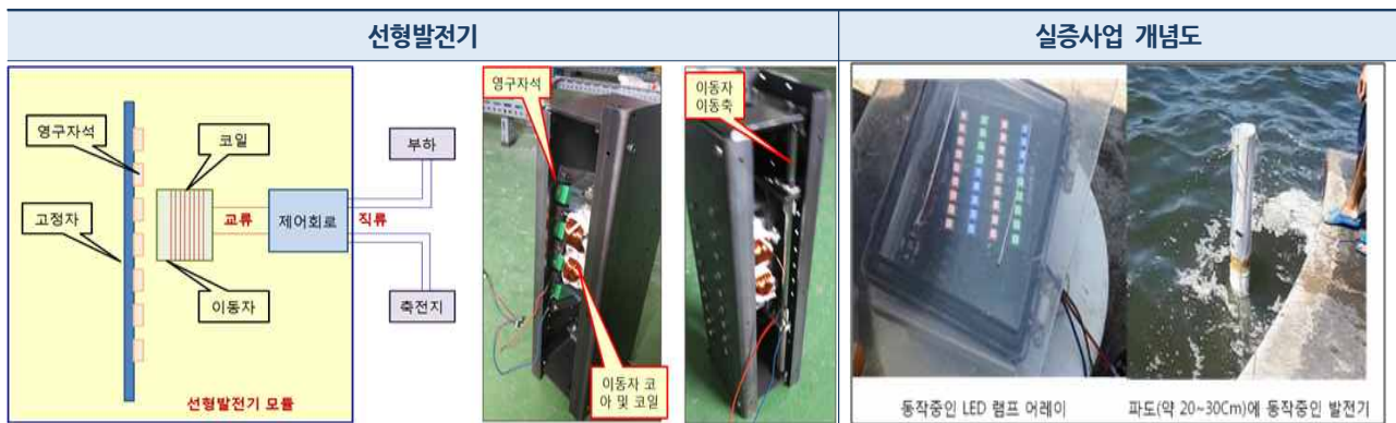
그림 5. 부력을 이용한 선형발전 모델 예시
