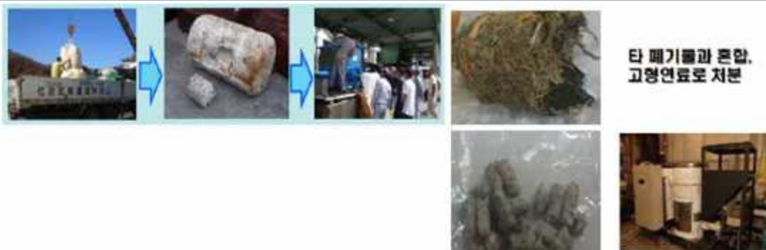
그림 8. 일본의 폐스티로폼 부표 처리 프로세스 및 자숙용 보일러 현장 사진
