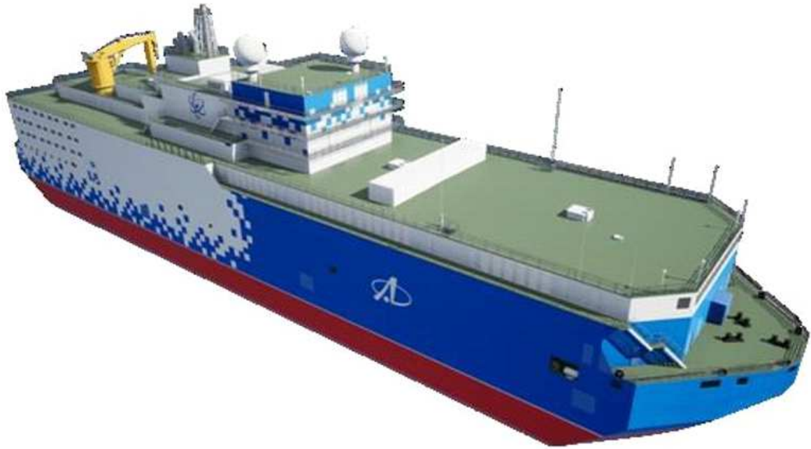
그림. 페벡 항구에 배치 예정인 부유식 발전 장치(MFPU)
