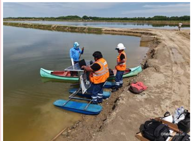
스리랑카·페루 새우 수생관리 강화를 위한 실시간 데이터 전송을 위한 양식장 센서 설치
