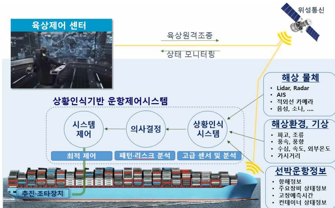
그림 5. 상태모니터링과 상황인식 운항제어 시스템 개념도
