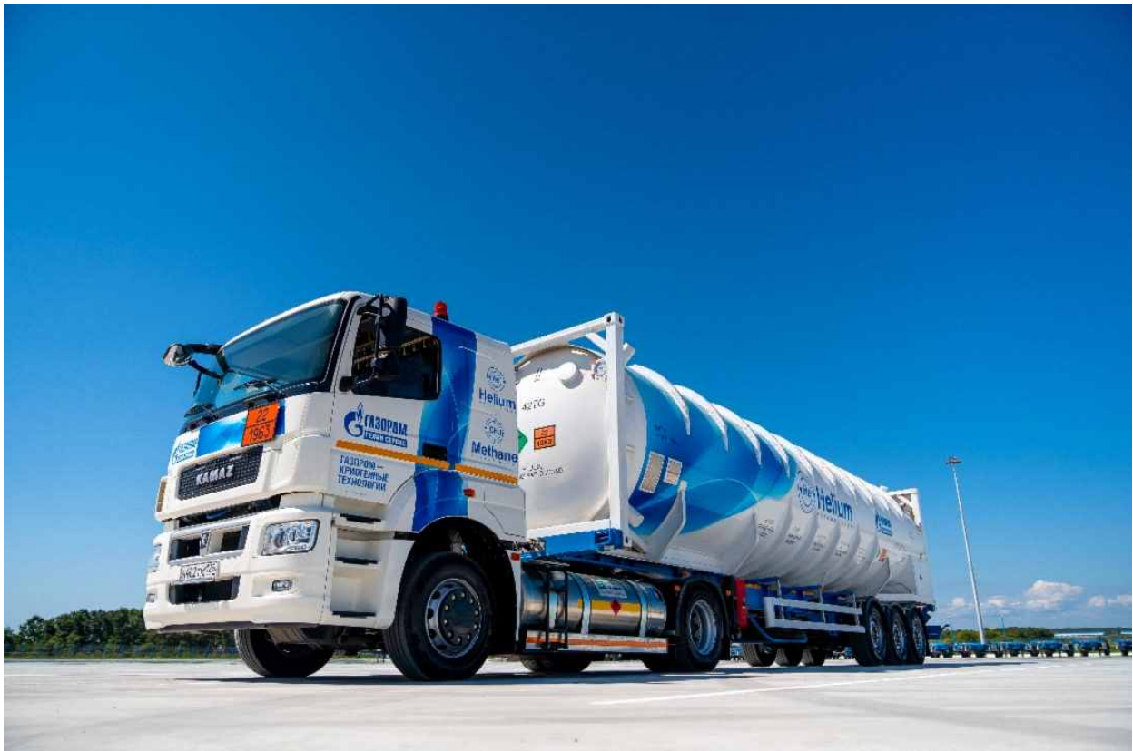
그림. 헬륨 운반 전용 트럭 KAMAZ-5490 Neo
