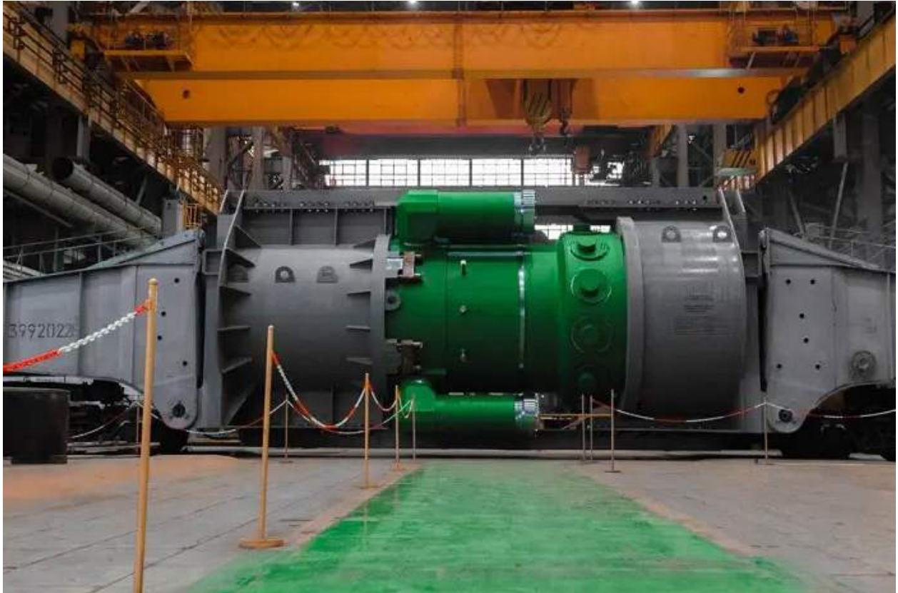
그림. ‘추코트카’ 원자력 쇄빙선용 첫 번째 RITM-200 원자로의 모습
