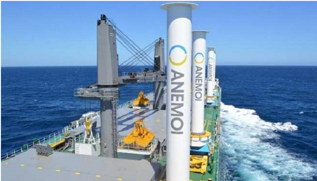
〈그림 1〉 선박에 설치된 로터세일 수직 실린더의 모습
